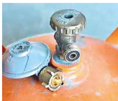
Ausländischer Druckregler passt nicht zusammen mit einer Schweizer Gasflasche.
